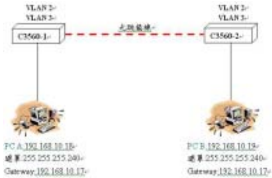
圖五 在不同 VLAN 間透過兩部 L3 SW 的連結測試
