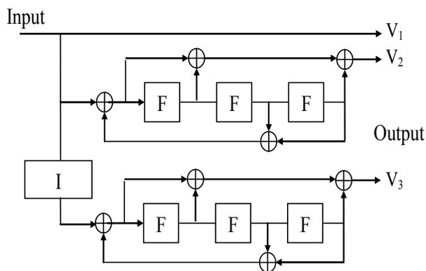
Fig. 5 The turbo encoder constructor for 3GPP
